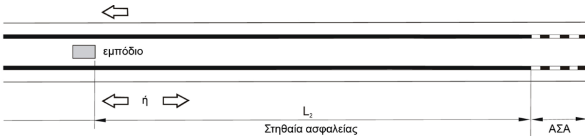
Σχ. 25: Στηθαία ασφαλείας με απολήξεις (ΑΣΑ) στην αρχή κεντρικής ή πλευρικής διαχωριστικής νησίδας
