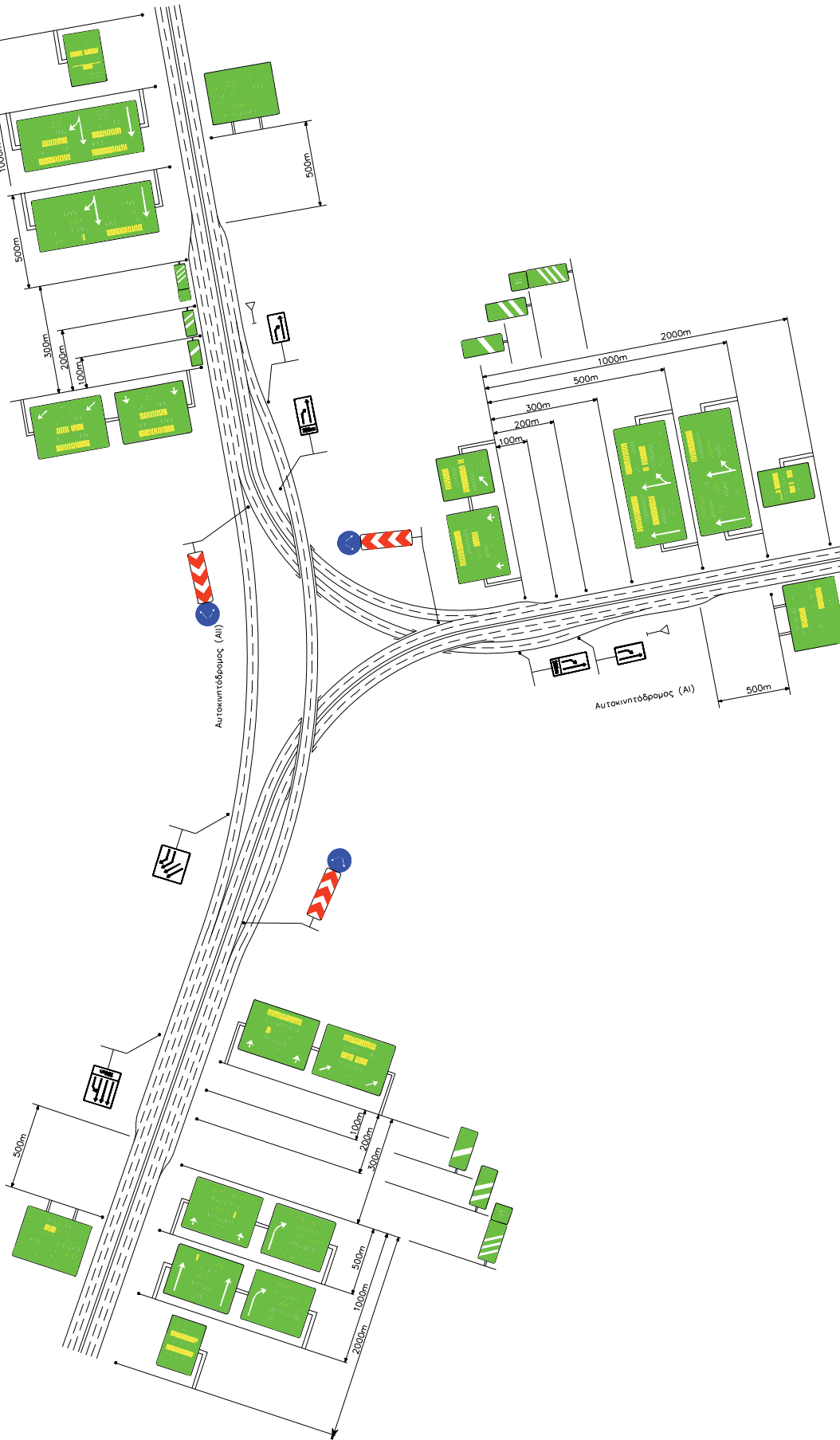
Σχέδιο 24: Συμβολή αυτοκινητοδρόμων (πρωτεύων ανισόπεδος κόμβος) – Τυπική σήμανση
